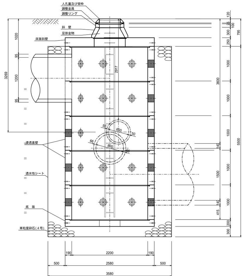
浸透管(遠心力鉄筋コンクリート管 B形 1200)構造図 縮尺 1:30
